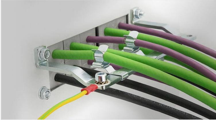
La barre collectrice CEM permet le clipsage des bornes de blindage PFS|SKL. Elle assure la conduite des perturbations à la masse. La barre collectrice est montée à l'aide des vis de fixation du cadre passe-câble.
